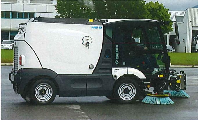
Le modèle Azura Flex MC 210 est le plus compact des trois. Il dispose de quatre roues directrices, d'un moteur Euro 6 de 62 kW ou d'un Tier 4 de 55.4 kW et d'une benne de 1.28 m<sup>3</sup> de capacité.
