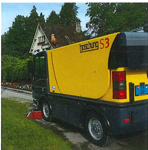
Cette entreprise nous propose le modèle Urban Sweeper S3, équipée de 4 roues directrices, d'une benne de 1.5 m<sup>3</sup> et d'un moteur Euro 6 d'une puissance de 84 kW.
