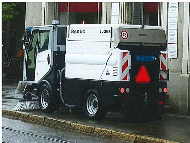
Ecologiquement, cette balayeuse domine le comparatif avec un moteur Euro 6C de 62 kW et un bac permettant d'utiliser de l'eau recyclée selon un système de circulation des fluides très élaboré.
